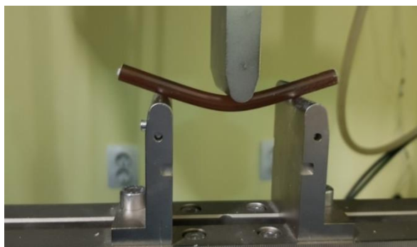
Fig. 2.24. Metoda de încovoiere în trei puncte.
