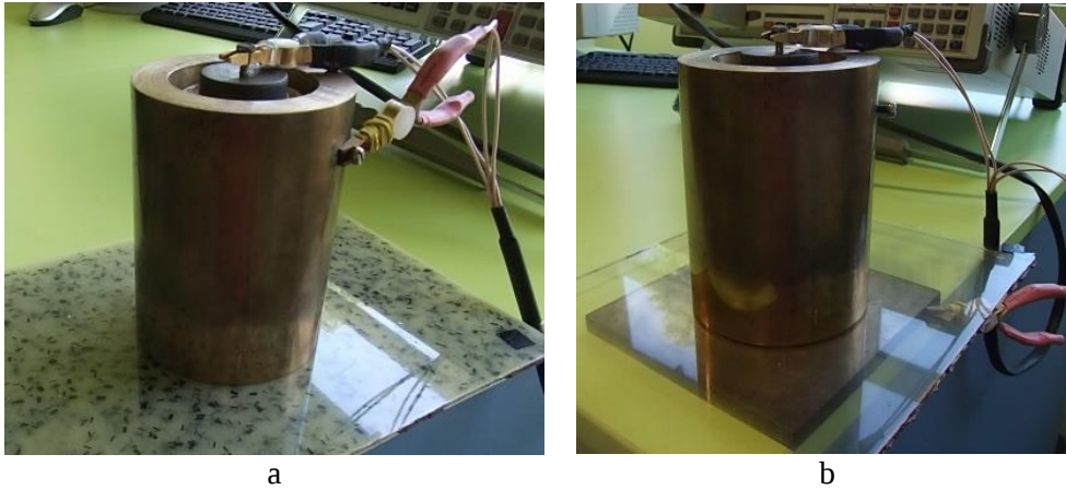
Fig. 2.10. Măsurători electrice de suprafață (a) și de volum (b).
