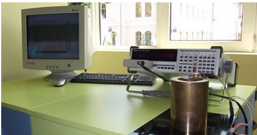
Fig. 2.8. Metoda experimentală de măsurare a parametrilor electromagnetici ale materialelor.
